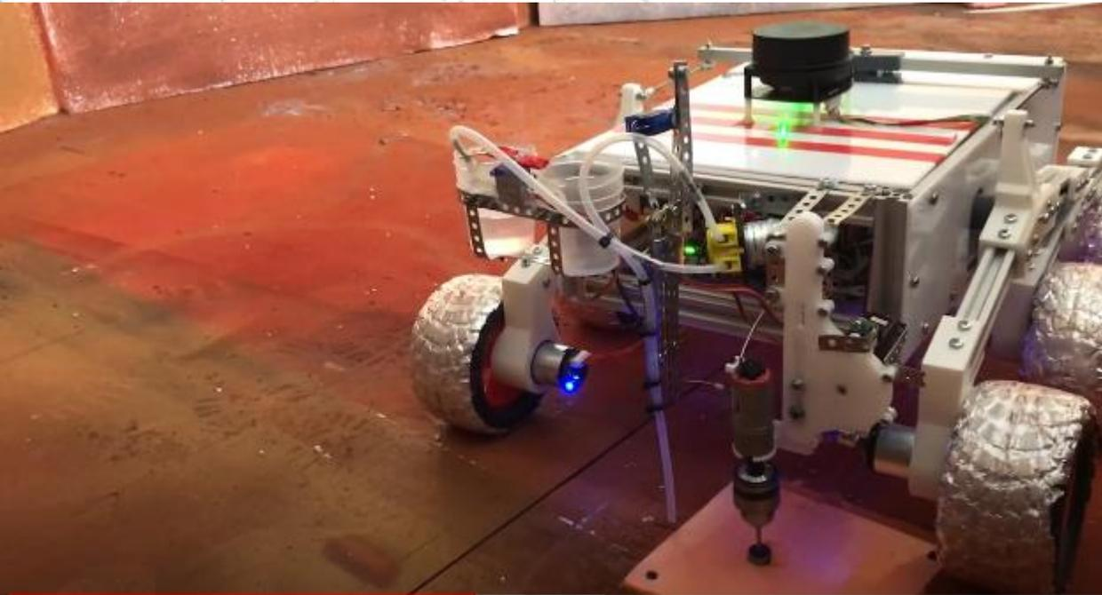
Команда в ручном режиме сверлит отверстие в зоне с водой и должна попасть в отверстие шлангом и закачать воду в другой резервуар.
